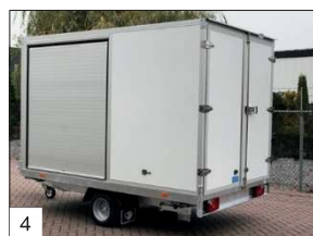
Option : volet roulant en aluminium (dimensions maximales : 180 cm de hauteur x 150 cm de largeur) s'ouvrant dans la paroi latérale.
