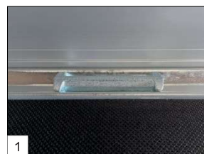
Ensérie : équipée de supports d'arrimage certifiés TÜV avec une capacité de 1 000 daN.
