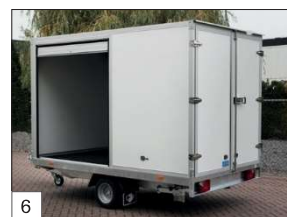
Option : volet roulant (dimensions maximales : 210 cm de hauteur x 150 cm de largeur) s'ouvrant dans la paroi latérale.
