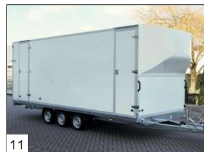
Option : remorque à trois essieux avec 2 portes latérales (à l'avant et à l'arrière) et déflecteur.
