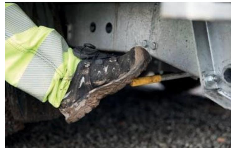
○ Béquilles stabilisatrices avec déploiement "coup de pied" pour faciliter le chargement par l'arrière.
