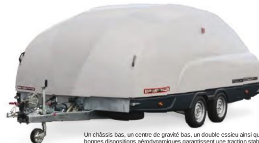
Un châssis bas, un centre de gravité bas, un double essieu ainsi que de très bonnes dispositions aérodynamiques garantissent une traction stable et sûre.
