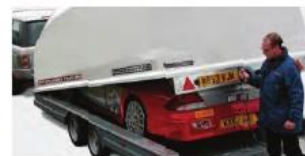
Verrouillage par poignées en inox, Ouverture assistée par vérin.
