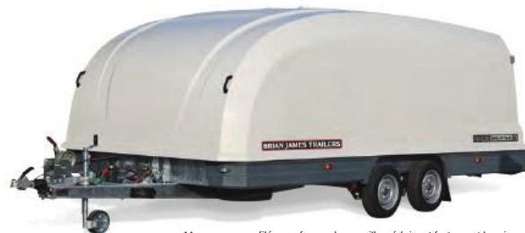
Monocoque profilée, en forme de coquille, réduisant fortement la prise au vent ainsi que la consommation de carburant du véhicule tracteur.
