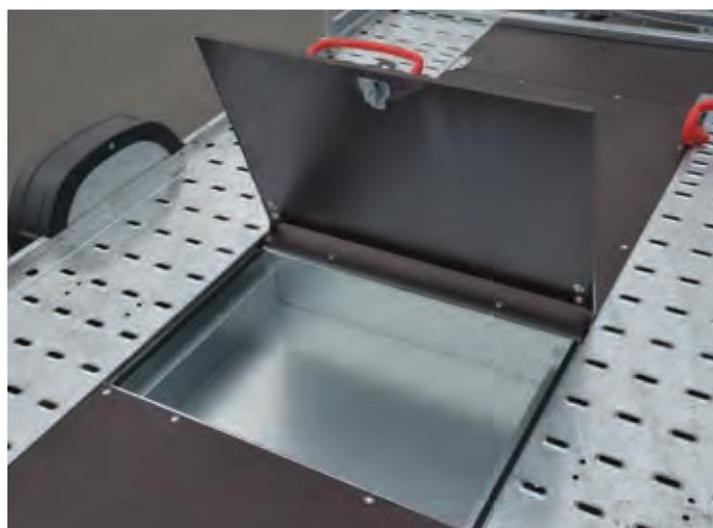
Dimensions intérieures : longueur 620 mm, profondeur 180 mm, largeur suivant largeur du plateau
