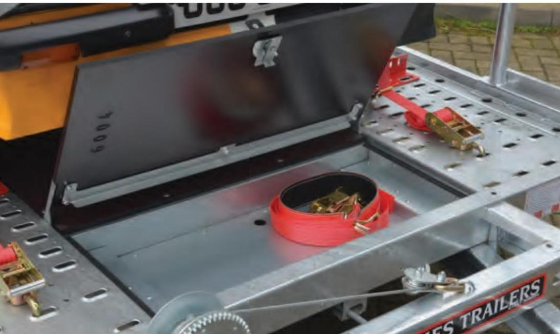
○ Coffre de rangement dans le plancher (avant) verrouillable par serrure, avec vérin d'assistance
