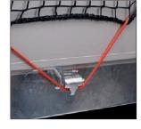
Des charnières articulées ingénieuses supplémentaires sont installées sur les modèles de base HB et HM. Les crochets permettent de fixer aisément le filet de chargement.
