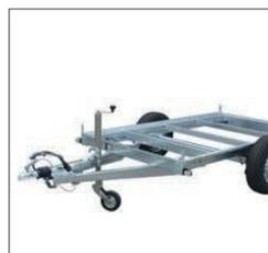
Grâce à leurs châssis robustes, les modèles Sapphire sont livrables avec des essieux simples avec une capacité brute de chargement de pas moins de 1800 kg ; les essieux doubles peuvent monter jusqu'à 3500 kg.
