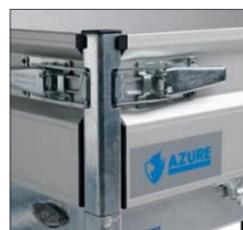
Toute la ligne Azure est équipée du verrouillage HAPERT : un verrouillage coulissant robuste et facile à utiliser et intégré, permettant d'avoir des ridelles (latérales) plates. Des câbles sont montés sur la ridelle en aluminium.
