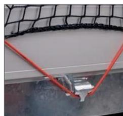
Des manchons articulés ingénieux supplémentaires sont installés sur les modèles H. Le crochet permet de fixer aisément le filet de chargement. Optionnel on a la possibilité de monter des crochets au-dessous de la côté latérale.
