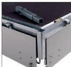
Les modèles H (remorque-plateau avec le plancher au-dessus des roues) sont livrés avec des charnières en aluminium rabattables anodisées, un panneau articulé et des piquets de coin amovibles.
