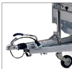
Tous les modèles à frein sont équipés d'un timon en V vissé, d'une roue jockey escamotable et d'un frein à inertie solide avec une tête d'attelage moulée.
