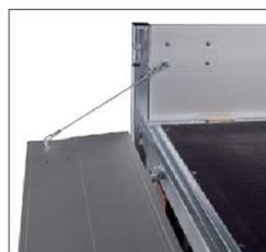
Les modèles H sont équipés d'un profilé en U à l'arrière. Ils ont également le dispositif pour une pose ultérieure d'un tiroir de rangement avec rampes sous le plancher (à l'exception du modèle H 260 x 150 cm).
