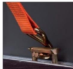
Les modèles Azure sont équipés de série d'anneaux d'arrimage latéraux avec une capacité de non moins de 1000 kg par unité. Ce système est certifié TÜV.
