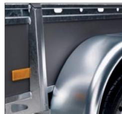
Les modèles L sont dotés de série de parois en multiplex. Les parois latérales sont disponibles en option en aluminium. Le Combi Protect Rail, les supports de parois latérales robustes, la porte-échelle avant amovible et les garde-boue en acier sont également de série avec ces modèles.
