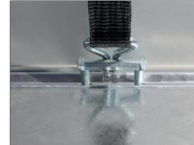
**En série :** système d'arrimage de chargement HAPERT certifié par TÜV : anneaux d'arrimage intégrés dans le plancher (1000 daN chaque)
