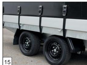
**Option :** les modèles Azure H avec suspensions paraboliques ont des pneus 185 R14C, 185/70 R13C ou 195/50 R13 avec des jantes noires.
