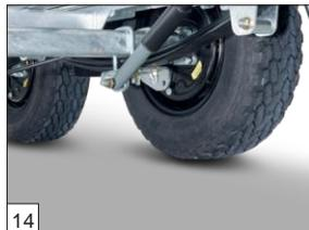
**Option :** les modèles Azure H en 3 500kg PTAC à partir de 335x180 sont livrables avec des suspensions paraboliques, plus amortisseurs. Les pneus 195/50 R13 ou 185/70 R13C sont avec des jantes noires.
