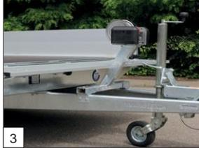
**Option :** treuil avec support monté sur le devant (uniquement possible avec des ridelles en 30 cm de hauteur)
