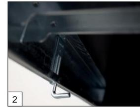
**Option :** possibilité de mettre des crochets boulonnables sous les ridelles
