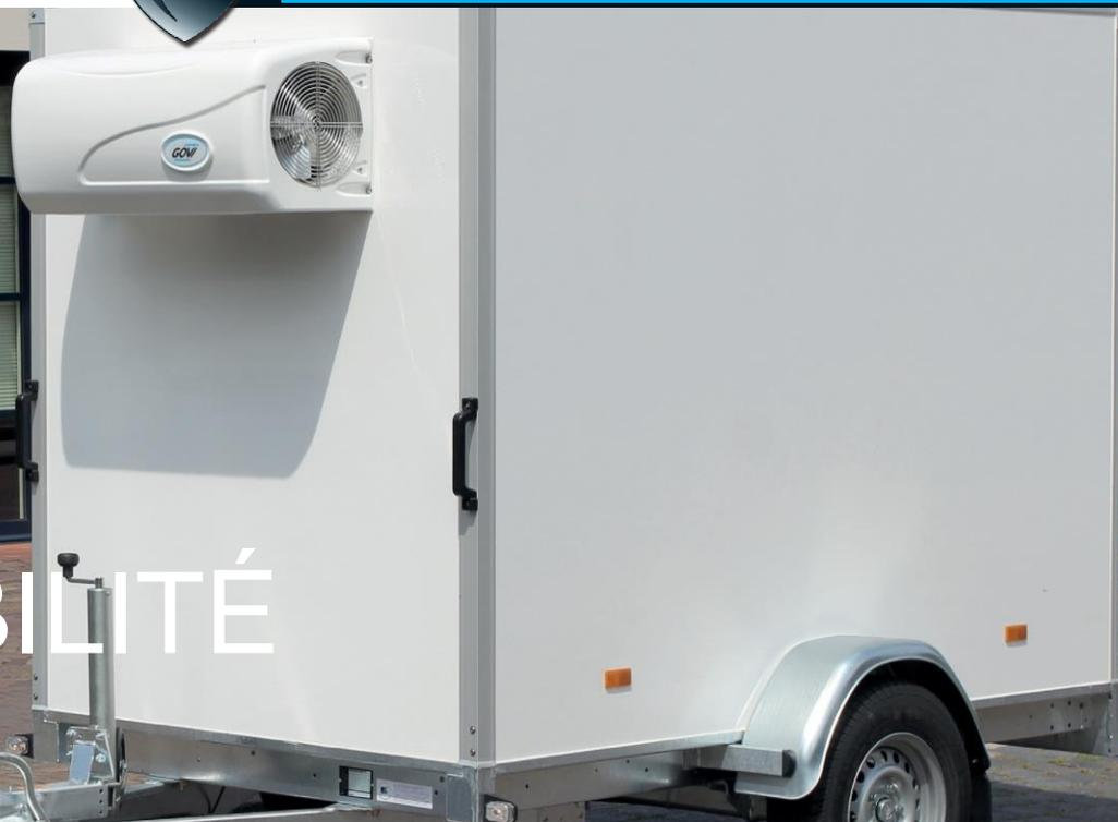
La remorque frigorifique Sapphire L possède une valeur d'isolation exceptionnelle grâce à l'isolation de son toit, de ses parois et de son plancher. La robuste structure fermée est montée sur un châssis entièrement auto-portant, ce qui permet d'utiliser cette remorque pour différentes activités.
