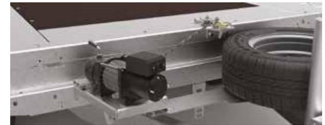
☉ **Treuil électrique 12v haute capacité**
