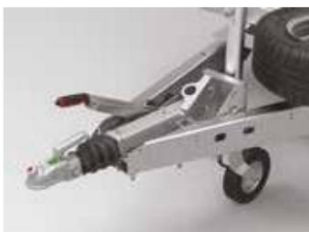
Sur les modèles équipés de plus grande taille de pneus, le timon est abaissé afin que l'attelage puisse être à niveau.
